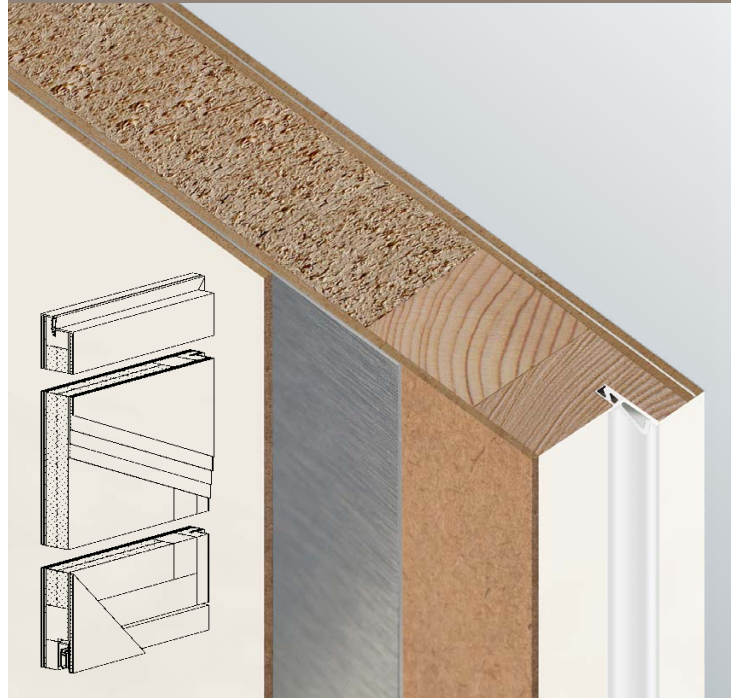
Türblattaufbau mit Aluminiumverbundabsperung
