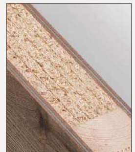
Klimaklasse III mit Aluminiumverbundabsperung
